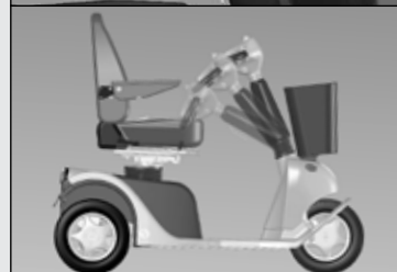
Abaisser la colonne de direction
